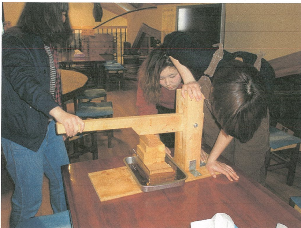
▲ 压榨機でもろみを搾る作業
